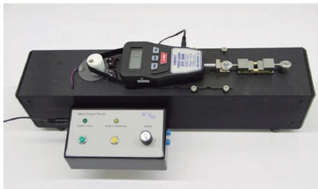
Figura 1. Máquina Bisco para registro de fuerza de cizalla
