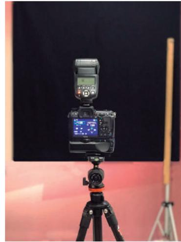
**Figura 1.** Set fotográfico, en donde se aprecia la cámara réflex digital (model Pentax K-3), en modo manual, puesta sobre un trípode, telón negro y regla de madera utilizados para la toma de fotografías.
